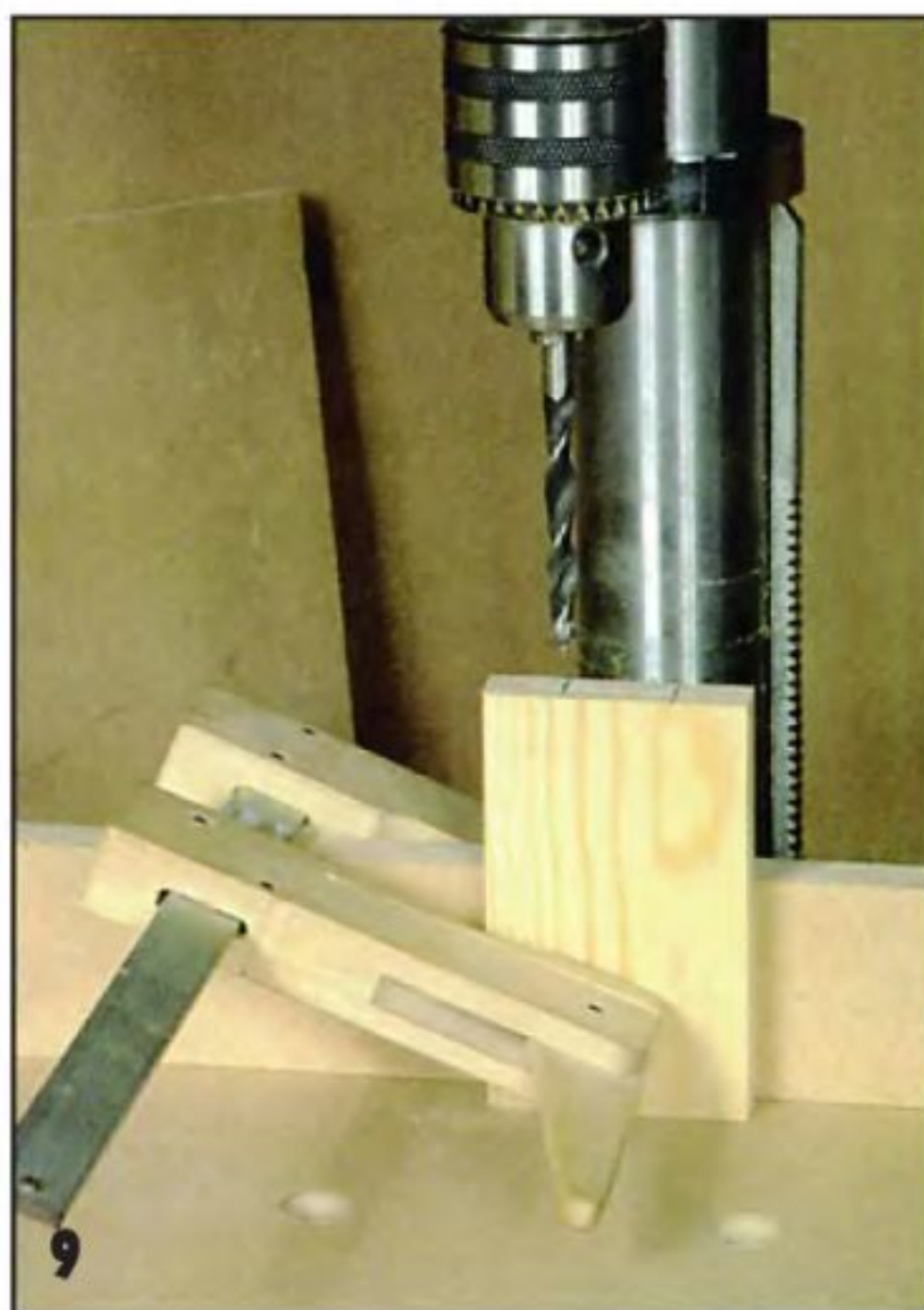
9 Установив деталь, её прижимают к упору струбциной.
