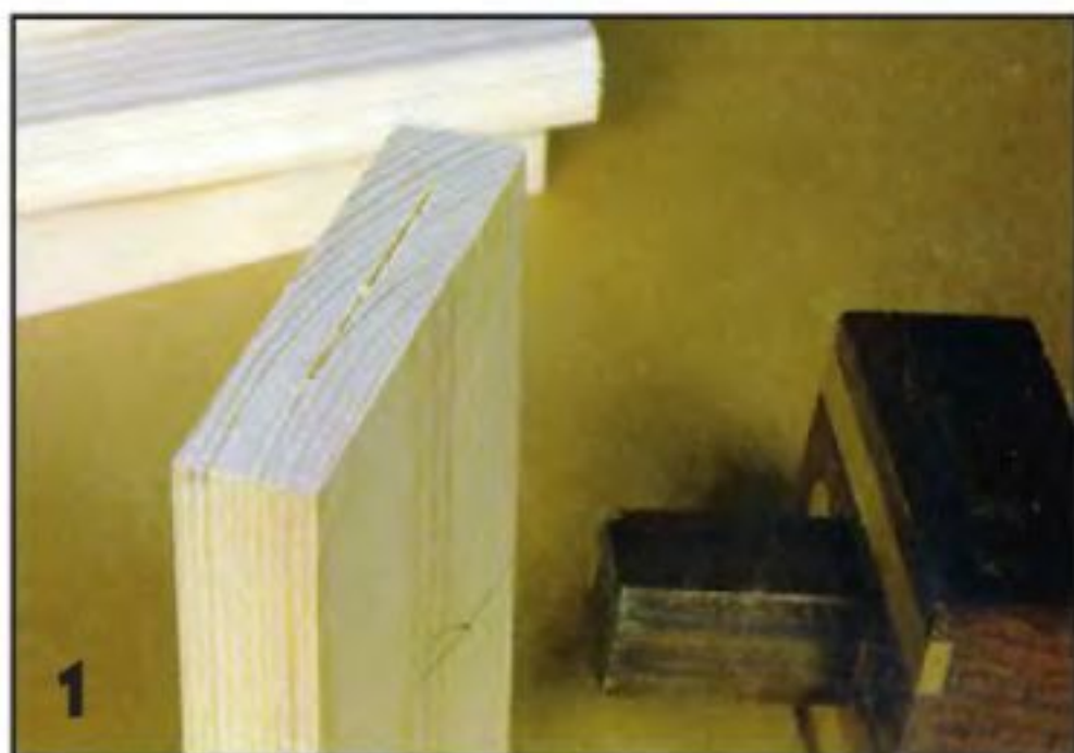
1 Рейсмусом на деталях размечают линии, на которых будут находиться центры отверстий под шканты.
