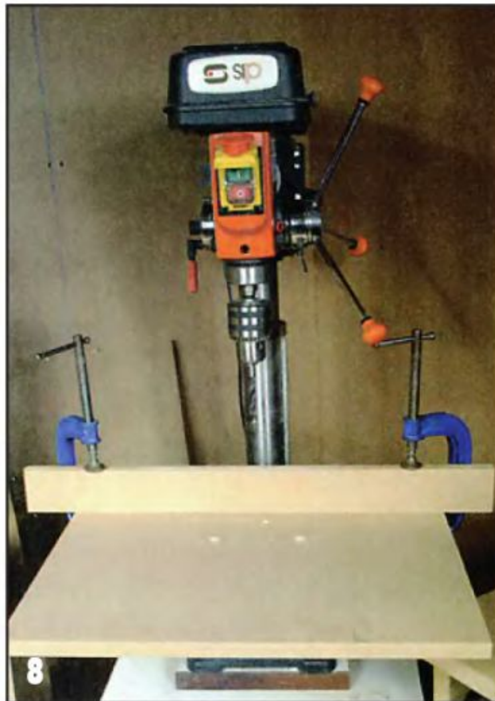
8 Упор, закреплённый на сверлильном станке, позволяет не тратить время на выставку детали при сверлении очередного отверстия.
