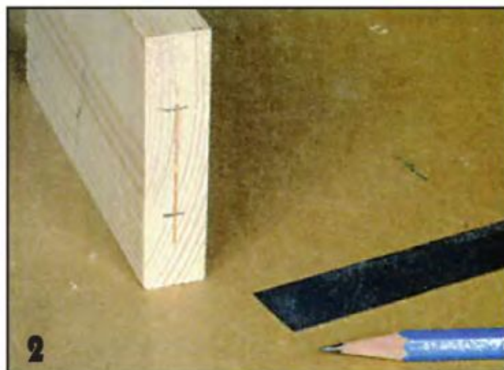
2 На соединяемых деталях размечают положение отверстий.
